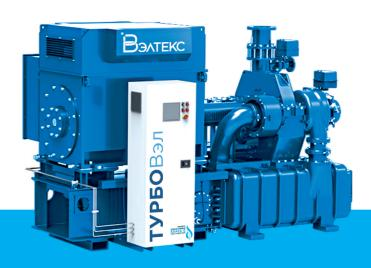
Центробежные компрессоры «ТурбоВэл» имеют диапазон рабочего давления от 2-х до 32 бар (изб.), производительности — от 20 до 1500 нм³/мин, количество ступеней — от 1-й до 4-х (в зависимости от требуемых параметров давления и производительности)
